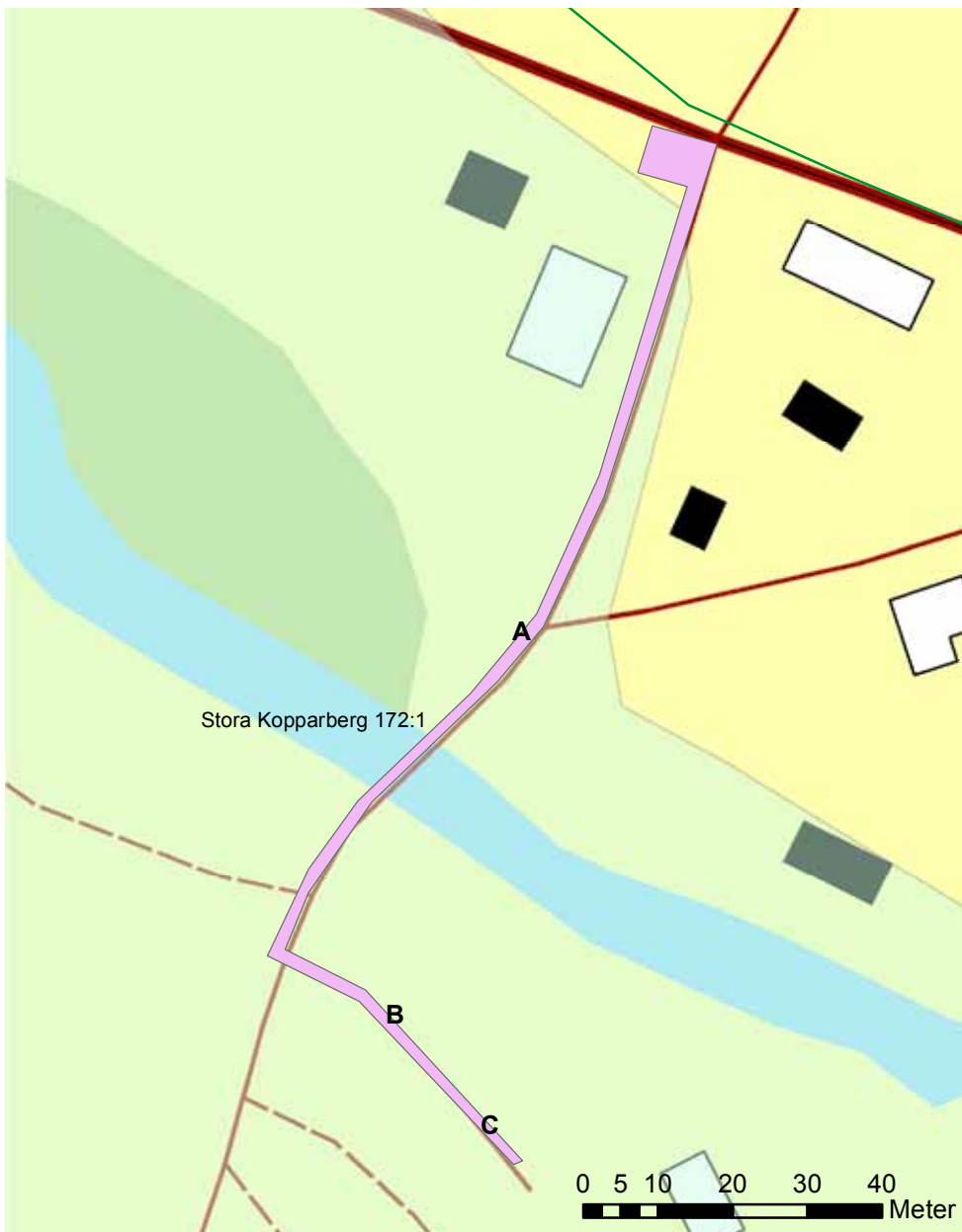
Figur 4. Schaktet i Bergsgården låg inom RAÄ-nr 172:1, Stora Kopparbergs socken, vilken utgörs av ett hyttområde. I schaktväggarna syntes ett homogent, påfört slagglager. Vid "A" och "B" fanns kolinslag i slagglagret. Vid "C" fanns röda lager i schaktets botten vilka troligen utgör resterna efter en kallrost. Skala 1:1 000.
