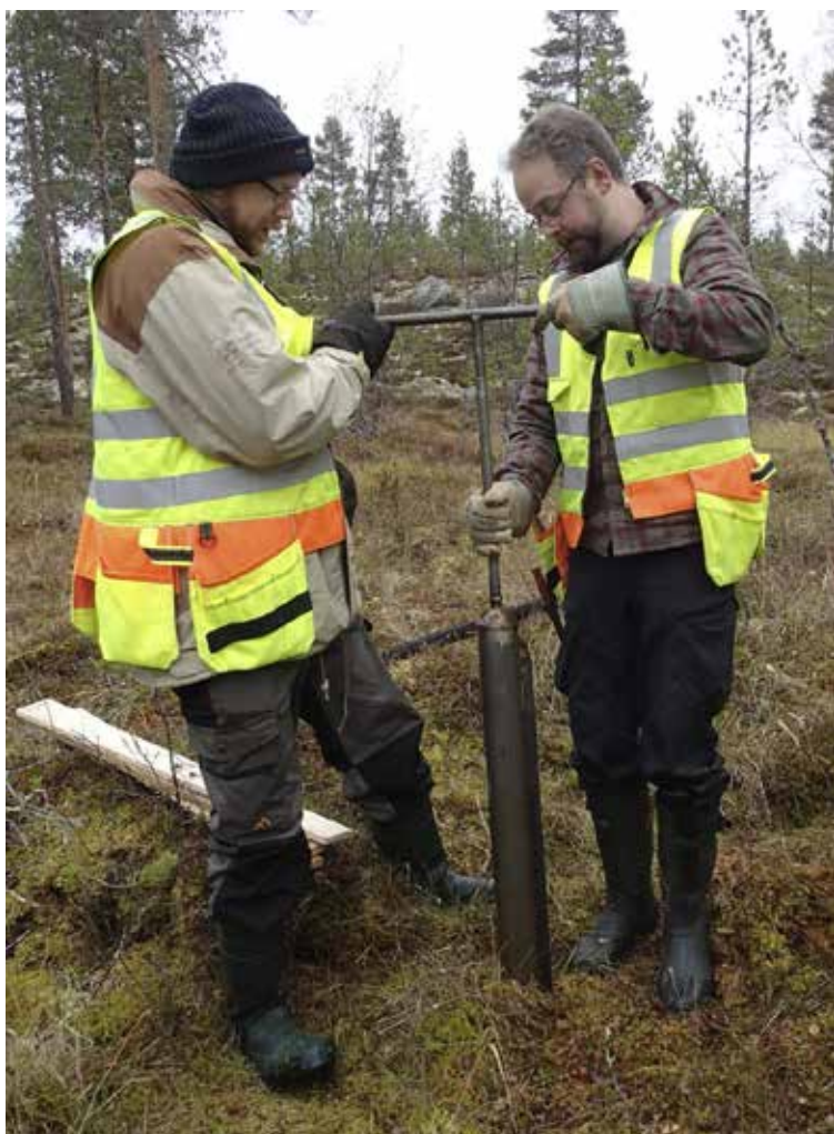
Figur 2. Provtagning vid punkt S2P2 med den ryska torvborren. Mattias Sjölander och Samuel Ericsson från MAL syns på bilden.
