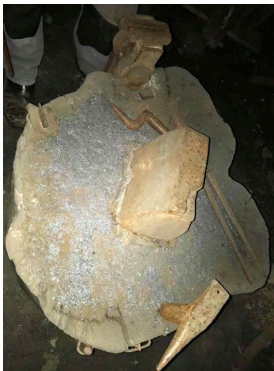
Figur 21. Stadsstabe med städ och glödskal i Mattias Heljes gammelsmedja. Foto: Greger Bennström.
