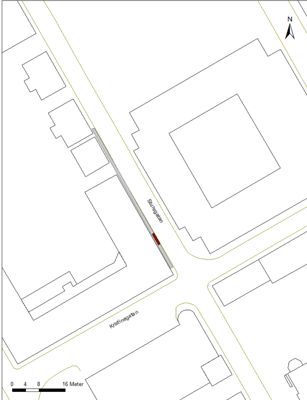
Figur 3: Utdrag ur fastighetskartan. Schaktet markerat med grått och kulturlagrets ungefärliga utbredning markerat med rött. Skala 1:475.
