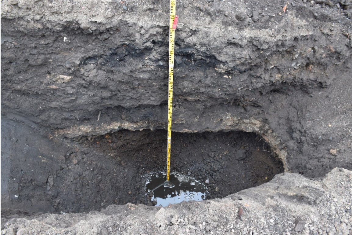
Figur 2: Vattnet strömmar in i botten av provgrop 2 vid cirka 2,5 meters djup. Endast slagg i botten av schaktet. Fotat från norr. Foto: Lee Widegren Lundin.
